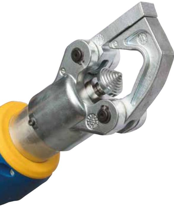
Um den großen Querschnittsbereich von 10 bis 240 mm<sup>2</sup> mit nur einem einzigen Werkzeug abdecken zu können, ist der Presskopf mit einem patentierten 2-Stufen-Teleskopzylinder ausgestattet: Das innovative System presst anfangs mit der maximalen Kraft von 60 kN (> 6 t), dann in der zweiten Stufe mit geringerer Kraft. Tiefe und Profil der Pressung passen Dank der Abstufungen des Pressdorns automatisch zum verarbeiteten Querschnitt.
